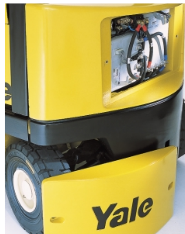
Gli impianti elettronici sono situati nel contrappeso, fornendo protezione contro la polvere e l'acqua.
